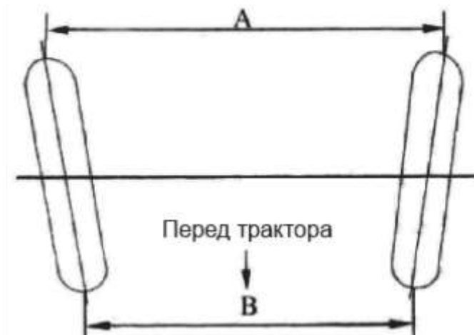
Рис. 3.22. Развал-схождение. Трактор. Вид сверху.
