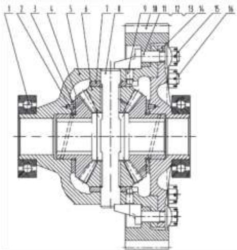
Рис. 3.10а. Дифференциал  $(3 \times 2 + 1)$  в сборе.
