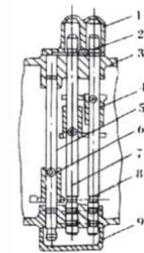
Рис. 3.12. Механизм внутренней блокировки (для коробки (3x2)+1.
