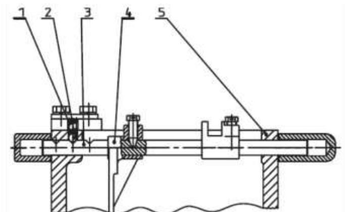
Рис. 3.11. Блокировочный механизм.
