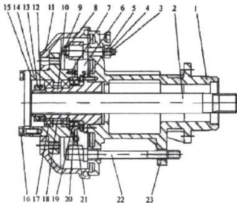
Рис. 3.16. Полуось и тормозная система (полностью плавающая полуось).
