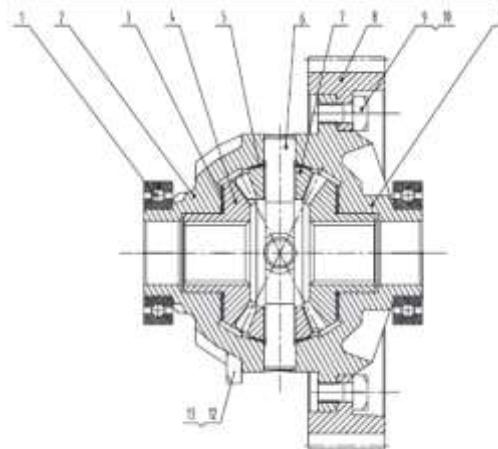
Рис. 3.10б. Дифференциал  $(4+1) \times 2$  в сборе.
