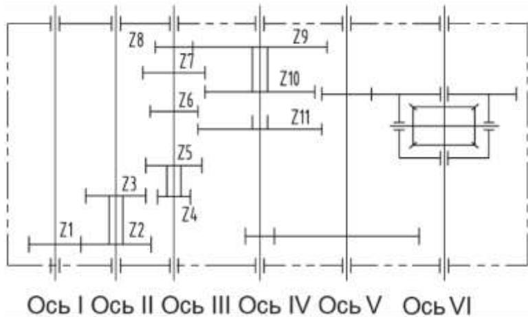
Рис. 3.4. Линия трансмиссии коробки передач 3x2+1.
