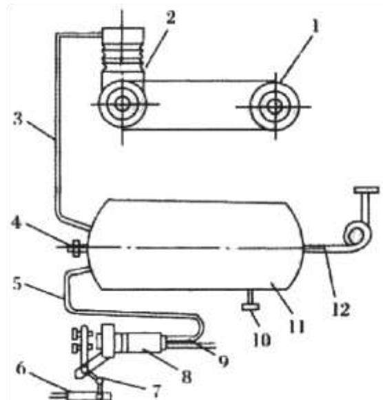
Рис. 3.18. Структура пневмотормоза.
