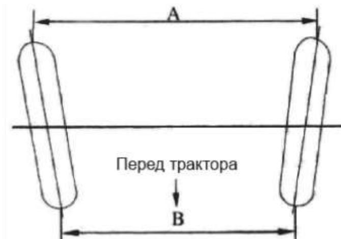
Рис. 3.22. Развал-схождение. Трактор. Вид сверху.
