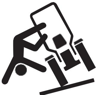
Всегда используйте ремень безопасности и убедитесь, чтобы конструкция защиты кабины была правильно установлена. Избегайте ям, канав и препятствий, которые могут привести к наклону или опрокидыванию трактора, особенно на склонах гор. Избегайте резких поворотов, а также поворотов на подъеме.
