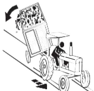
Производите переключение на низшую передачу перед началом спуска с крутого холма в целях улучшения управления трактора с незначительным или вообще без торможения. Используйте двигатель для торможения, чтобы снизить скорость перед началом использования тормозов.
