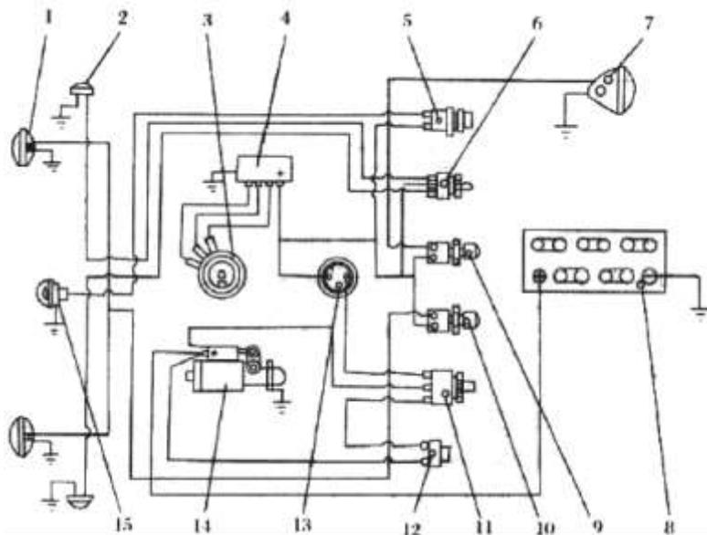
Рис. 3.40. Схема электрического оборудования трактора с электрозапуском.
