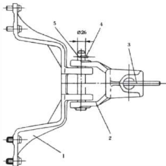
Рис. 3.38. Буксирное приспособление.
