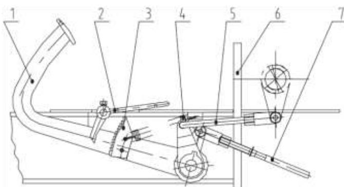
Рис. 2.7. Тормозная система.
