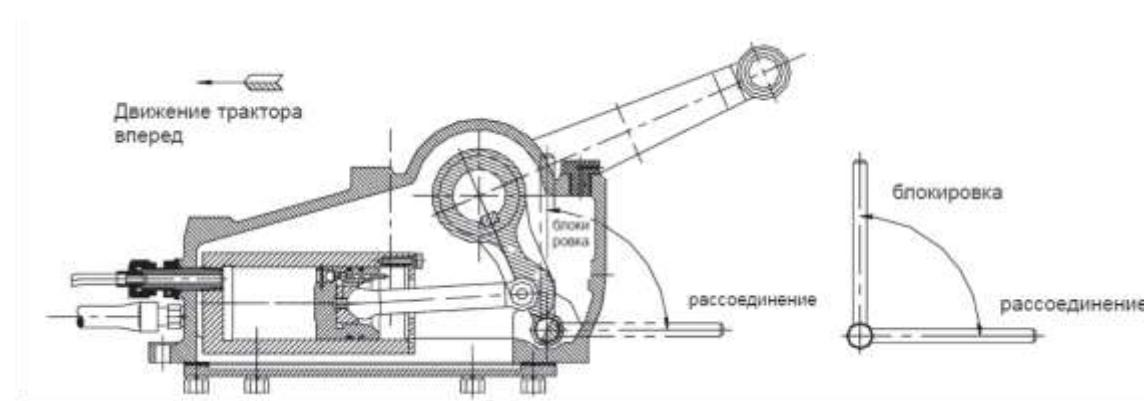
Рис. 2.10. Рычаг блокировки сцепного устройства.
