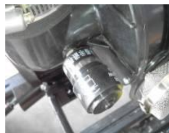
Сигнализация блокировки воздушного фильтра сухого типа
