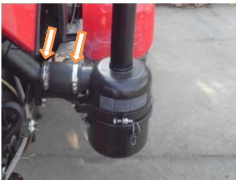
Зажим воздушного фильтра в масляной ванне
