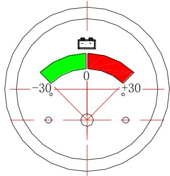
Рис. 3.6. Амперметр
