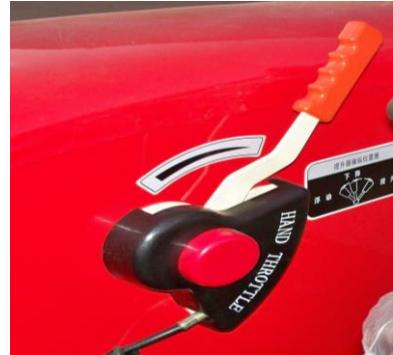
Рис. 3.16. Ручной акселератор
