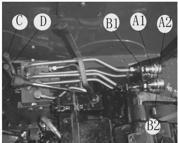
Рис. 3.25. Многоканальный клапан
