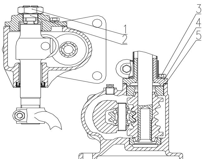
Рис.5-8 корректировка картера рулевого управления
