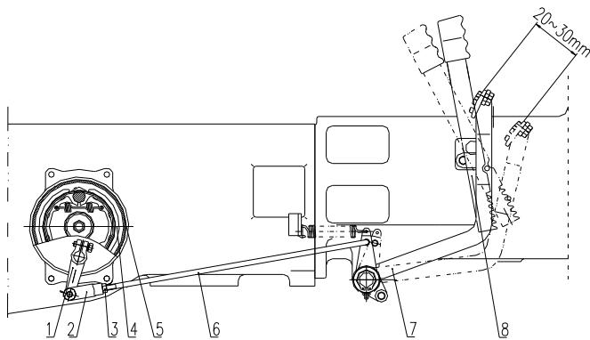
Рис.5-4 тормозная система
