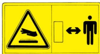
Смыслоное значение: во время работы машины следует держатель определенное расстояние от горячей поверхности машины, чтобы избежать телесных повреждений.
