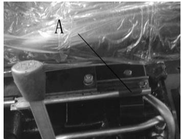
Рис. 3.22..Регулировка водительского сидения
