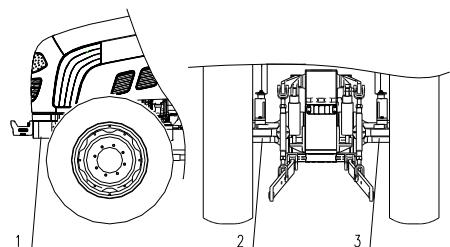
Рис. 1-7. Точки поддомкрачивания
