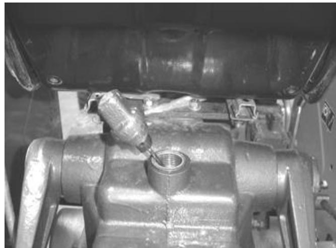
Рис.5-29 маслоуказатель подъемника
