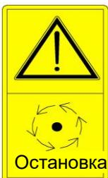
Смыслоное значение: только после полной остановки всех движущихся частей машины, допускается контакт с ними, чтобы избежать телесных повреждений.
