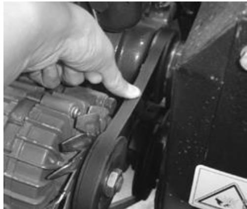
Рис. 5-21 Регулирование натяжения резиновой ленты вентилятора
