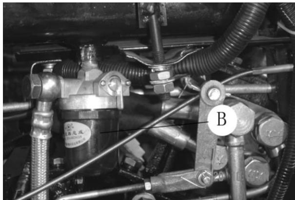
Рис.5-32 Отстойник топливного бака
