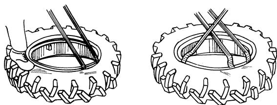
Рис. 3.20. Демонтаж шины
