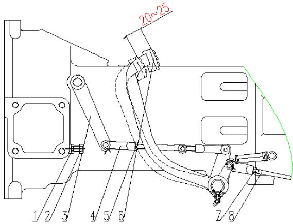
Рис. 5-2 схема управления сцепления
