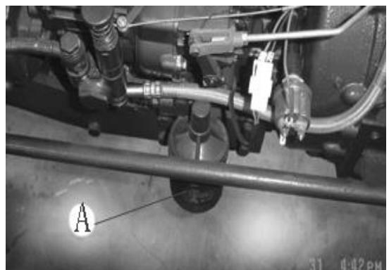
Рис.5-25 Уход и содержание фильтра машинного масла
