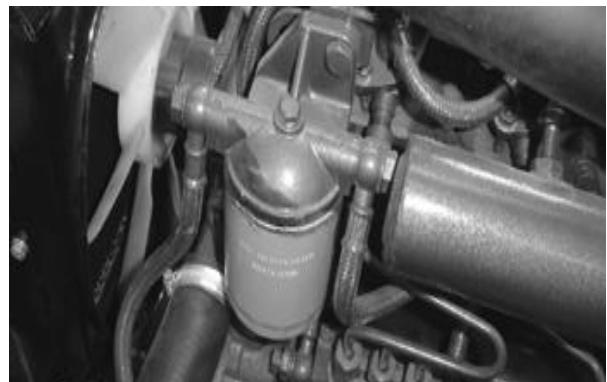
Рис.5-24уход и содержание топливного фильтра
