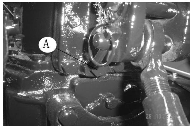
Рис.5-30 пробка смазки
