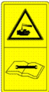
Смыслоное значение: при проведении технического обслуживания аккумулятора, см. правильный порядок технического обслуживания, установленный в руководстве по эксплуатации.
