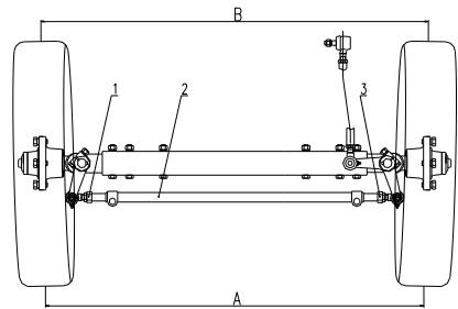
Рис. 5-11 Корректировка переднего пучка переднего колеса
