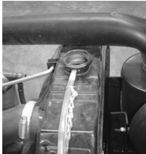
Рис.5-33 уход и содержание системы охлаждения
