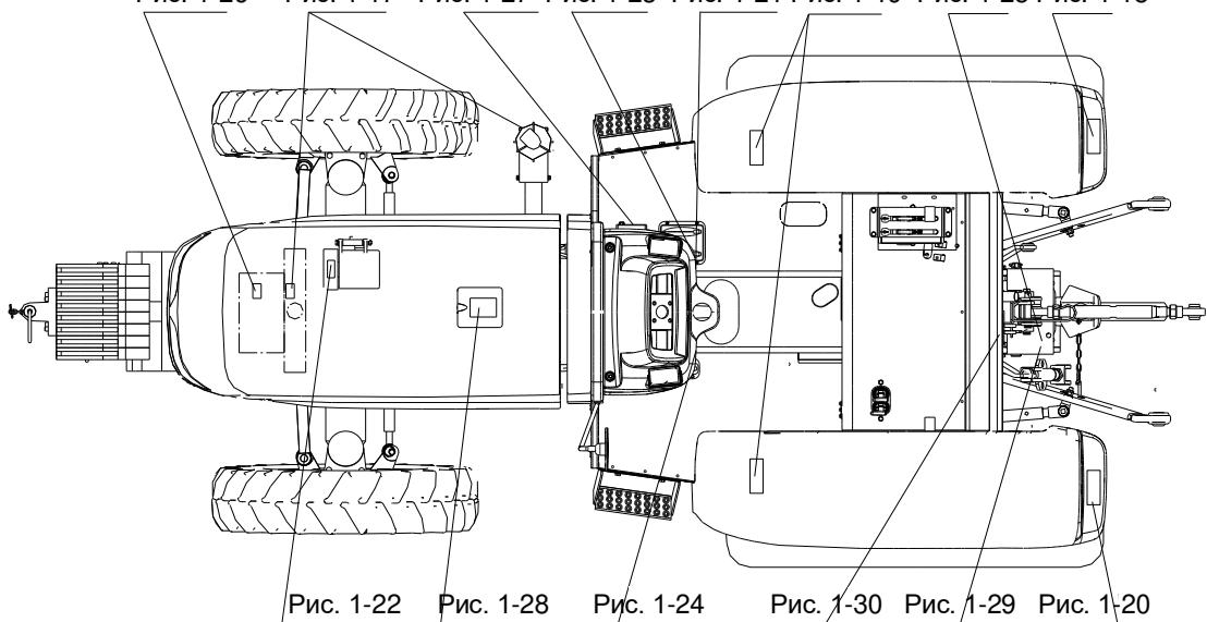
Рис. 1-31. Схема расположения предупреждающих знаков
