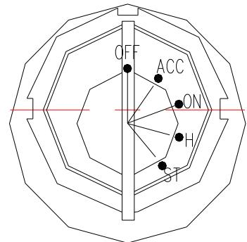
Рис. 3.15. Замок зажигания
