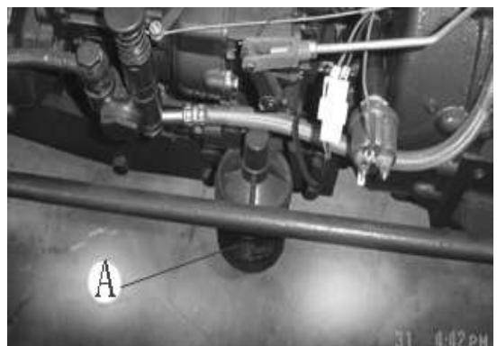
Рис.5-25 Уход и содержание фильтра машинного масла
