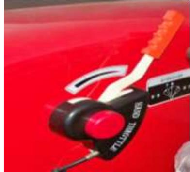
Рис. 3.16. Ручной акселератор
