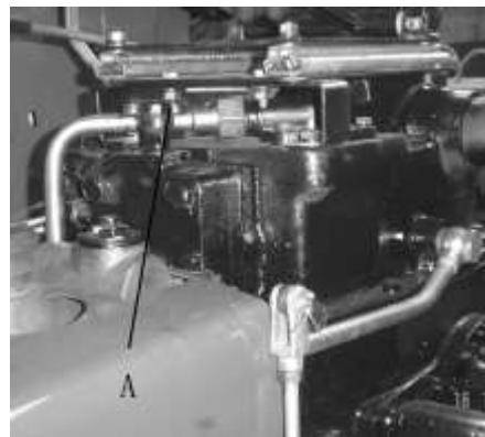
Рис. 3.23. Схема регулировочного клапана
