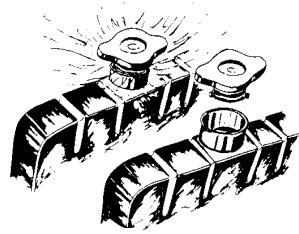
Рис. 1-14. Откручивание крышки радиатора
