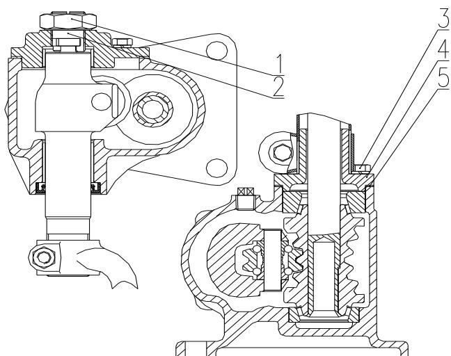
Рис.5-8 корректировка картера рулевого управления
