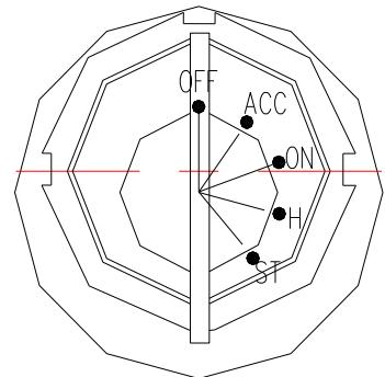
Рис. 3.15. Замок зажигания
