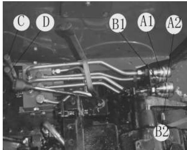
Рис. 3.25. Многоканальный клапан
