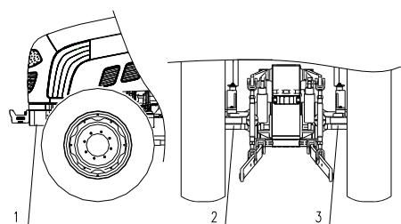
Рис. 1-7. Точки поддомкрачивания
