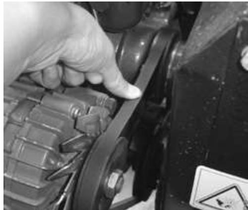
Рис. 5-21 Регулирование натяжения резиновой ленты вентилятора
