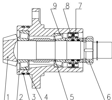
Рис.5-14корректировка центральногой трансмиссии для переднего приводного моста
