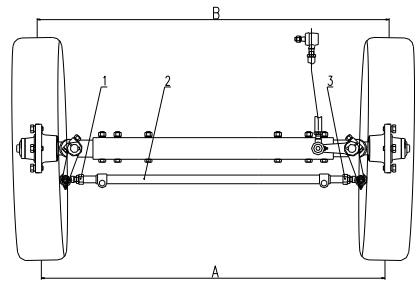
Рис. 5-11 Корректировка переднего пучка переднего колеса
