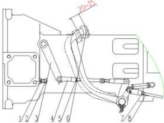
Рис. 5-2 схема управления сцепления
