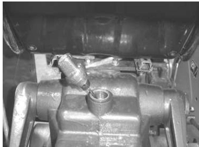
Рис.5-29 маслоуказатель подъемника
