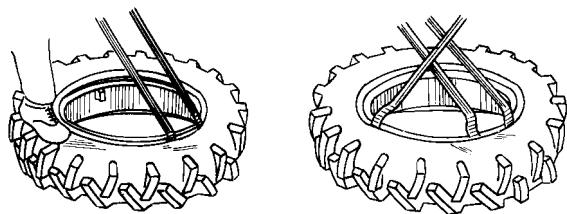
Рис. 3.20. Демонтаж шины
