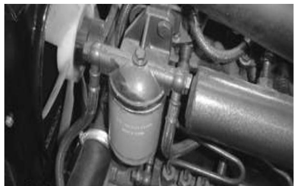
Рис.5-24уход и содержание топливного фильтра
