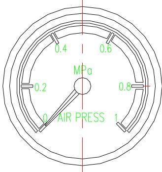
Рис. 3-7. Манометр
