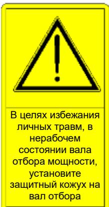
В целях избежания личных травм, в нерабочем состоянии вала отбора мощности, установите защитный кожух на вал отбора
