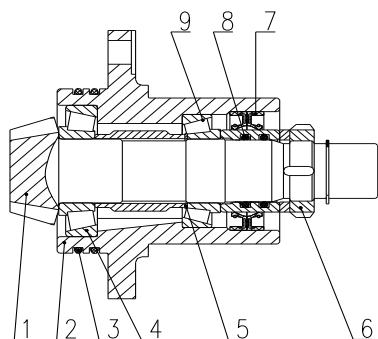
Рис.5-14 корректировка центральной трансмиссии для переднего приводного моста
