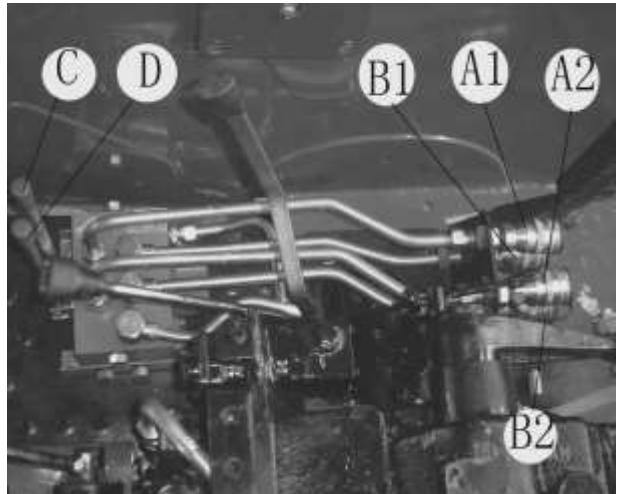
Рис. 3.25. Многоканальный клапан
