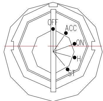
Рис. 3.15. Замок зажигания
