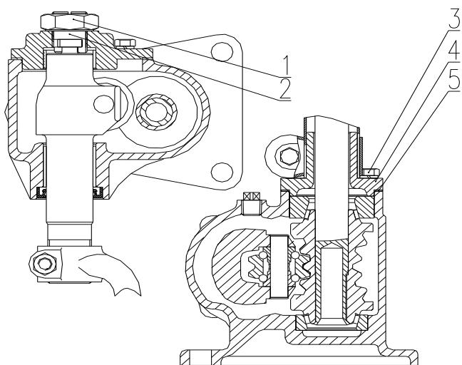
Рис.5-8 корректировка картера рулевого управления
