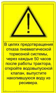
В целях предотвращения отказа пневматической тормозной системы, через каждые 50 часов после работы трактора, откройте водовыпускной клапан, выпустите накопившуюся воду из ресивера.
