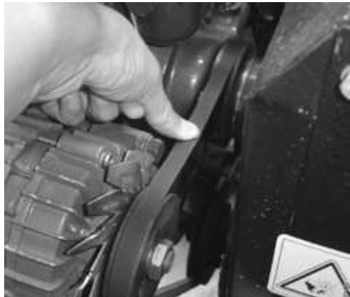
Рис. 5-21 Регулирование натяжения резиновой ленты вентилятора
