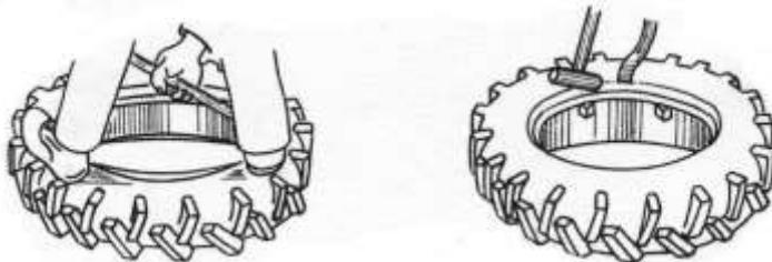
Рис. 3.21. Монтаж шины
