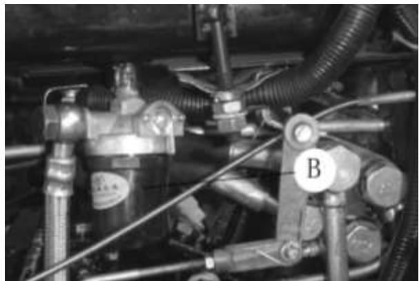
Рис.5-32 Отстойник топливного бака
