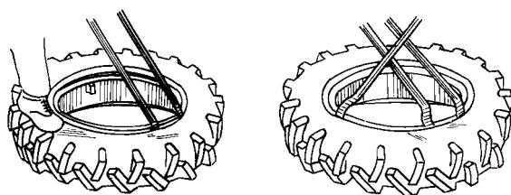
Рис. 3.20. Демонтаж шины
