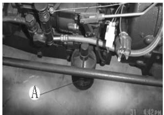
Рис.5-25 Уход и содержание фильтра машинного масла
