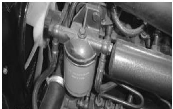
Рис.5-24уход и содержание топливного фильтра
