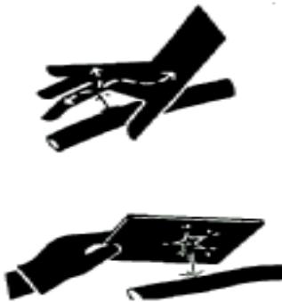
Рис. 1-9. Утечка из гидравлического трубопровода
