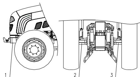
Рис. 1-7. Точки поддомкрачивания
