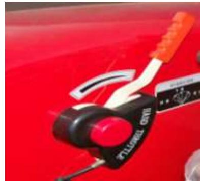
Рис. 3.16. Ручной акселератор
