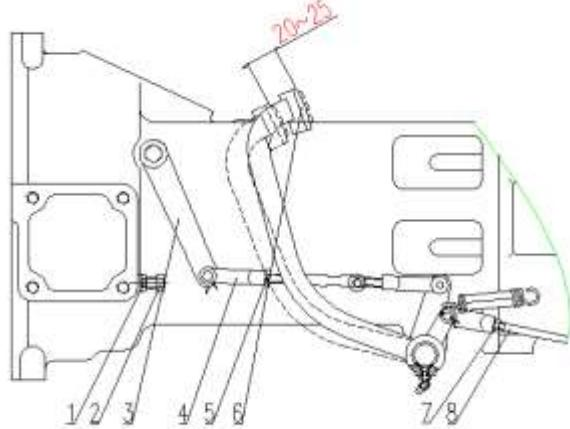
Рис. 5-2 схема управления сцепления
