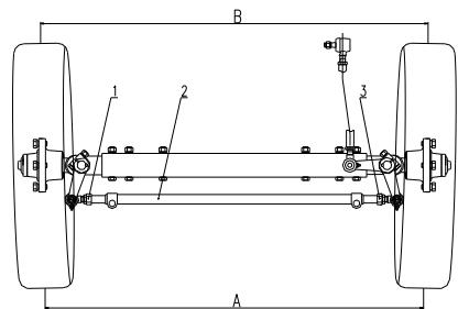
Рис. 5-11 Корректировка переднего пучка переднего колеса
