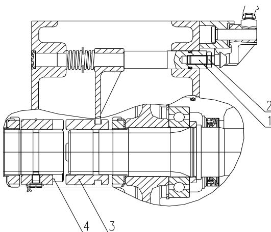
Рис. 5-7 корректировка замка дифференциала
