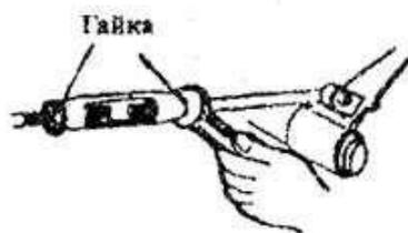
Рис.12 Регулировка тормоза (1)
