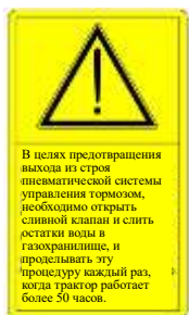
Рис. 1-31 Предупредительные идентификаторы пневматического тормоза
