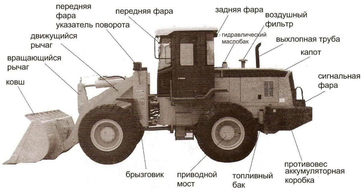
Рис.1-1 Внешний вид погрузчика и наименование деталей
