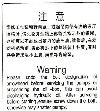
Если при ремонте рабочего насоса, рулевого насоса в гидравлическом маслобаке есть гидравлическое масло, открутите пробку бака. Это позволит не спускать мало из бака. После ремонта перед запуском двигателя закрутите пробку, в противном случае масло не поступит в маслопровод и это приведет к поломке шестерчатого насоса.
