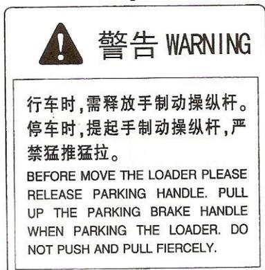
При движении необходимо отпускать рычаг управления ручным тормозом. При остановке поднимите рычаг ручного тормоза. Запрещено резко отпускать и резко поднимать рычаг.
