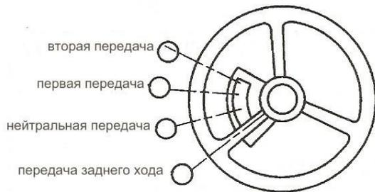
Рис. 1-12 Положения рычага переключения
