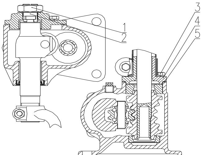
Рис.5-8 корректировка картера рулевого управления
