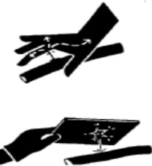
Рис. 1-9. Утечка из гидравлического трубопровода
