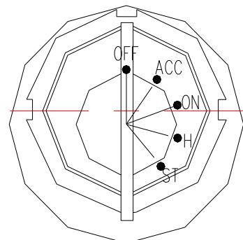
Рис. 3.15. Замок зажигания
