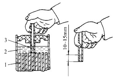
Рис. 5-19 проверка состояния аккумулятора
