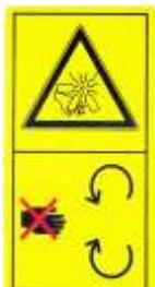
Смыслоное значение: во время работы двигателя, нельзя открыть или снять капот, также протягивать руки в зону работы, чтобы избежать телесных повреждений.
