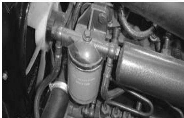
Рис.5-24 Уход и содержание топливного фильтра
