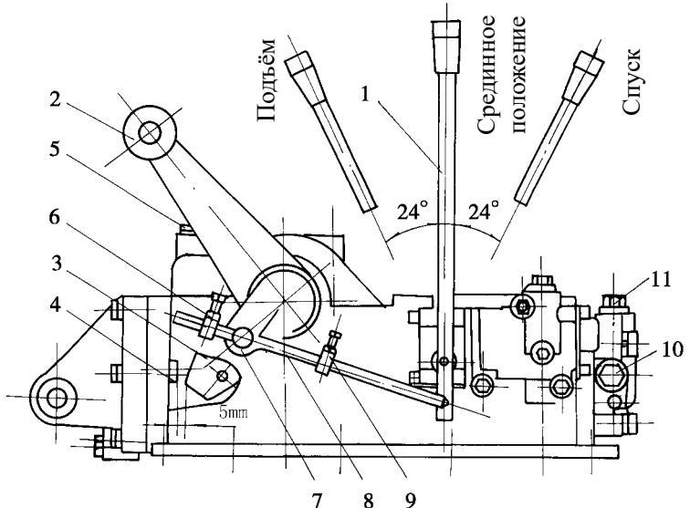
Рис.5-17 корректировка подъемного места
