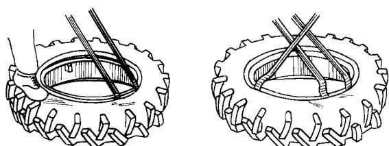
Рис. 3.20. Демонтаж шины
