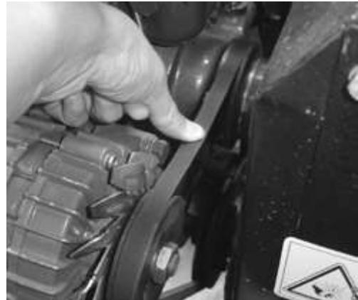
Рис. 5-21 Регулирование натяжения резиновой ленты вентилятора
