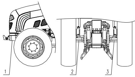
Рис. 1-7. Точки поддомкрачивания
