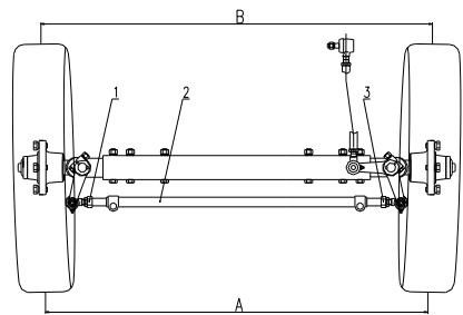
Рис. 5-11 Корректировка переднего пучка переднего колеса
