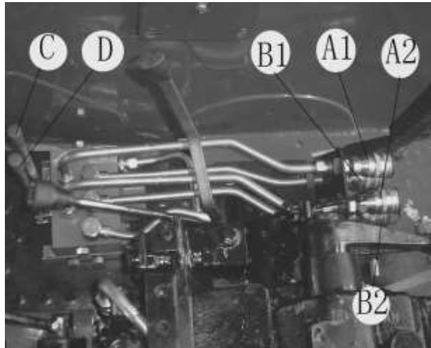
Рис. 3.25. Многоканальный клапан
