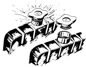
Рис. 1-14. Откручивание крышки радиатора
