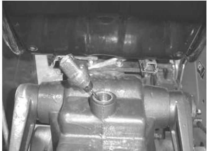
Рис.5-29 маслоуказатель подъемника
