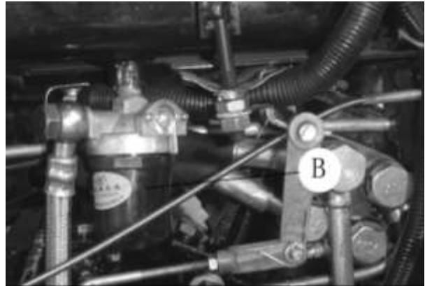
Рис.5-32 Отстойник топливного бака
