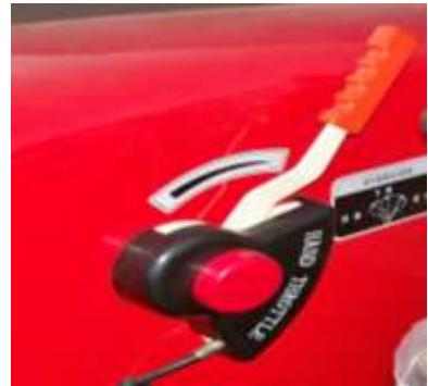
Рис. 3.16. Ручной акселератор
